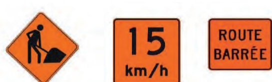
Affichage des zones de chantier
