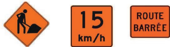
Affichage des zones de chantier
